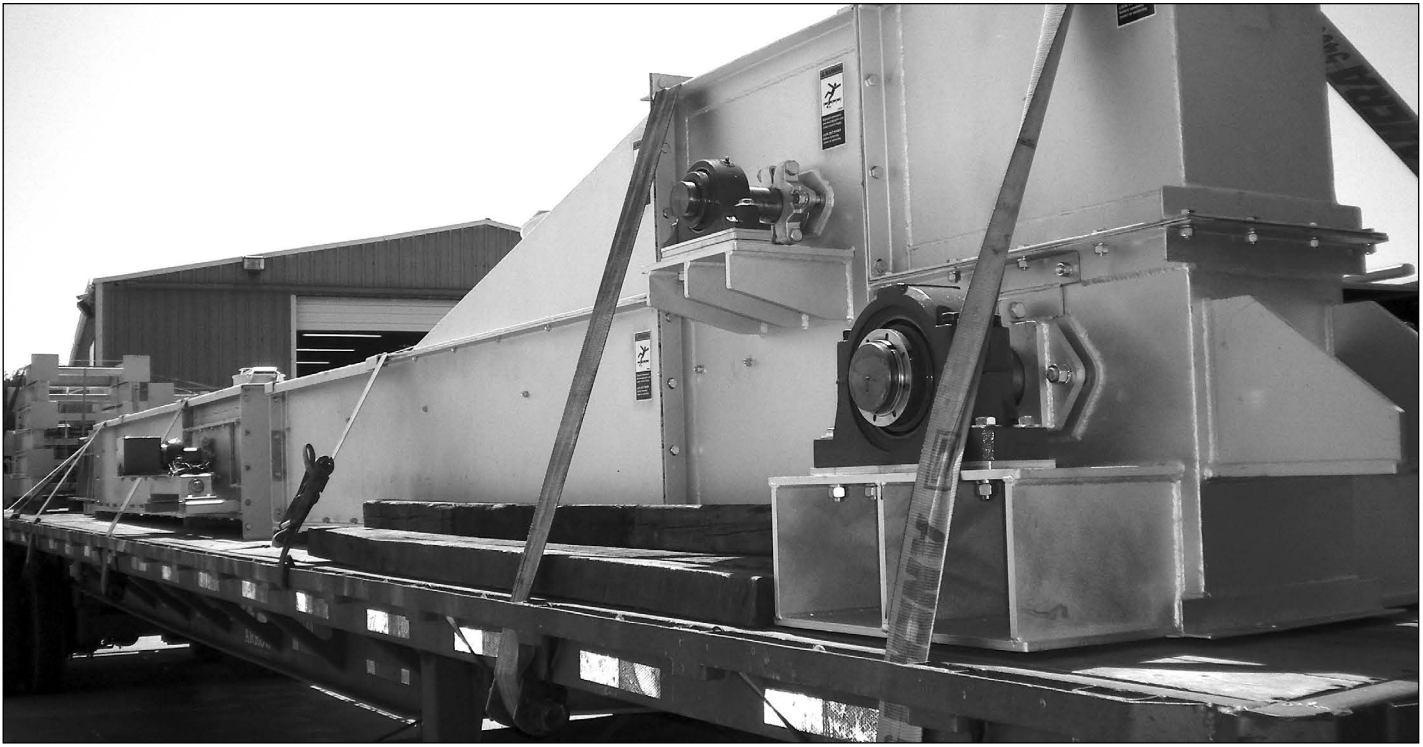
Cabeça com Sprocket Esticador do Lado Frouxo de um Transportador de Corrente de Super Capacidade eMSC
